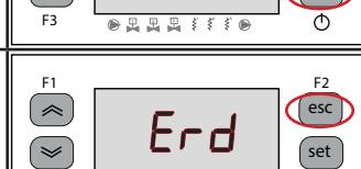
Con el parámetro ERD activado: La temperatura de ajuste del agua cambia en función de la temperatura ambiente. La función solo está activa si el control de precisión de la temperatura está desactivado (CPT=OFF).
