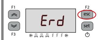
Lorsque le paramètre ERD est activé : La température de consigne de l'eau change en fonction de la température ambiante. La fonction n'est active que si le contrôle de la précision de la température est désactivé (CPT=OFF).
